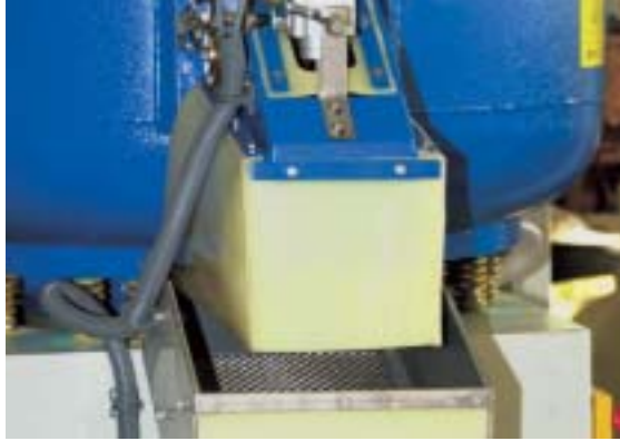
Pneumatikus tartályürités (opció). A nagy felületű pneumatikus üritőszerkezet lehetővé teszi a teljes üritést.
